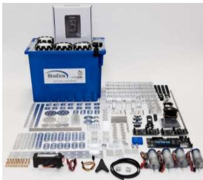
图 1 BNRT-MOB-45 型移动机器人套件
